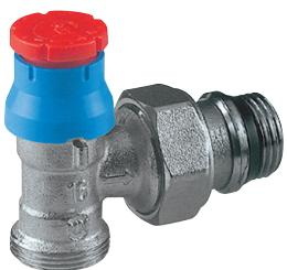
Клапан термостатический угловой, хромированный с наружной резьбой под переходник, монтажным защитным колпачком и отводом с герметичным уплотнением.
